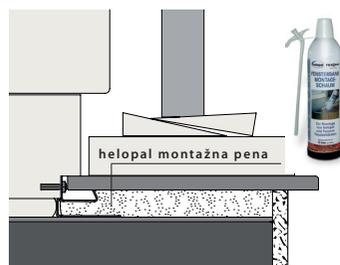
**Pozor:** Uporabite dvokomponentno (2K) helopal montažno peno in upoštevajte navodila za uporabo.
